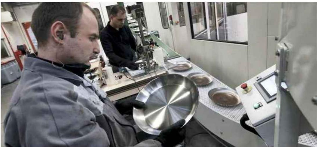
**Contrôle visuel des pièces embouties et polies. Toutes les opérations de fabrication ne peuvent pas être réalisées par des machines. L'œil affûté des salariés reste très précieux.** Photo Francis REINOSO
